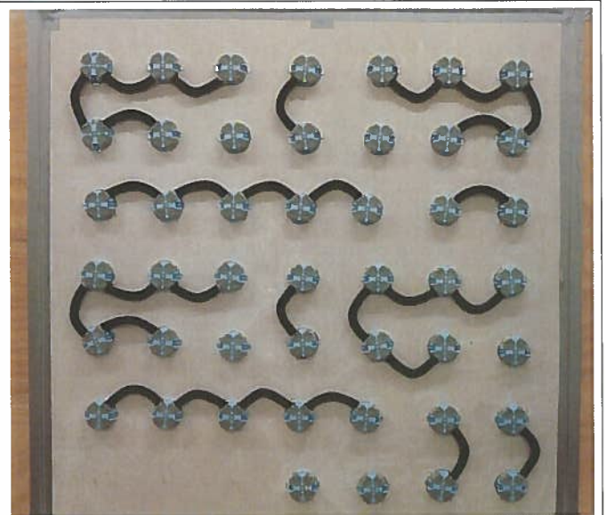
Figure 9 – Raccordement par gaine et mise en œuvre des boîtes d'encastrement sur le caisson d'essais
